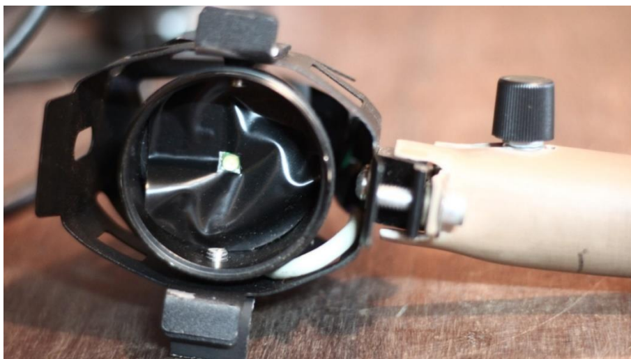
Imagen 19 – Lámpara de mano de LED de alta luminosidad, realizada por Alexandre Fávero y Paulo Sicca Lopes.
